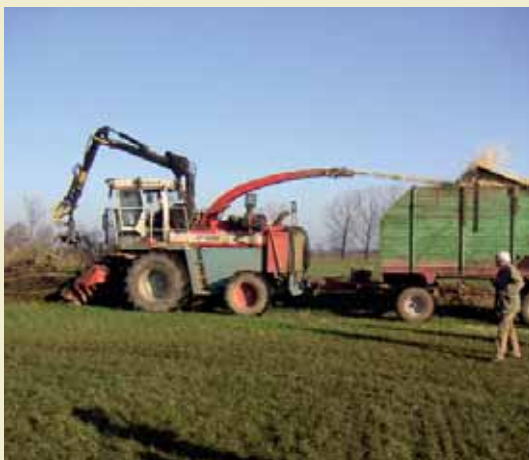
In Schleswig-Holstein wird das anfallende Holz aus der Wallheckenpflege direkt vor Ort gehäckselt und der energetischen Nutzung zugeführt.
