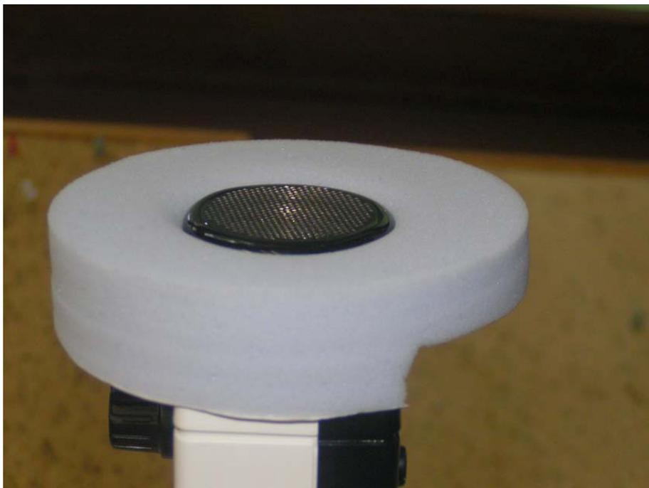
**Abbildung 11** Aufstecken der Schaumstoffscheibe auf den Anabat SD1: Das Mikrofon sollte in einer Ebene mit der Schaumstoff-Front angeordnet sein. Die Ausparung im Schaumstoff sollte nach Hinten und zur Unterseite des Anabat SD1 weisen
