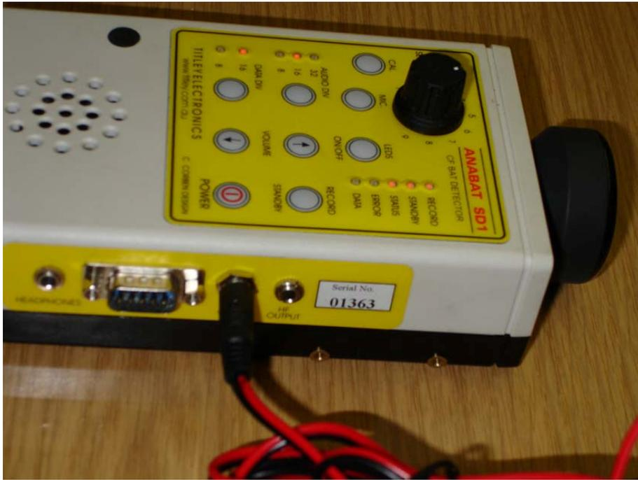
**Abbildung 13** Buchse für das Stromversorgungskabel des Anabat SD1
