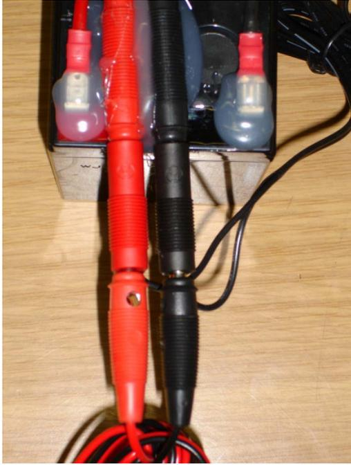
**Abbildung 4** Steckverbindung Akku-Bananenbuchse, Doppelstecker des Ladegerätes und Bananenstecker des Stromversorgungskabels (gleich für beide Recorder, jedoch verschieden eingestellte Ladegeräte und verschiedene Akkus!)
