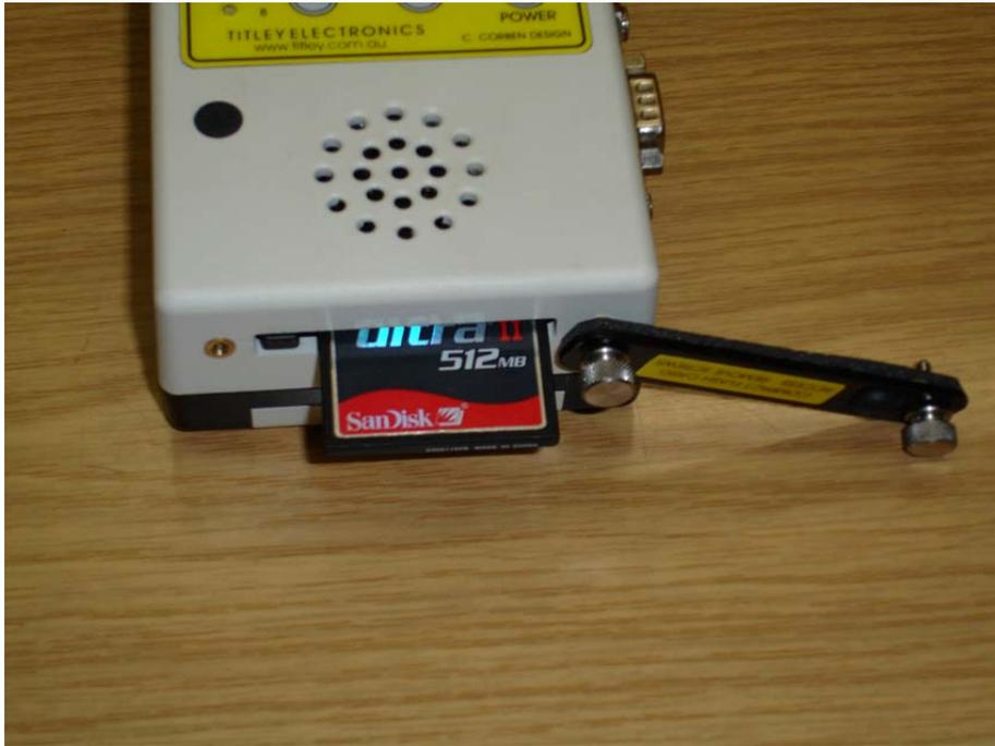
**Abbildung 10** Einlegen bzw. Wechsel der CF-Karte beim Anabat SD1
