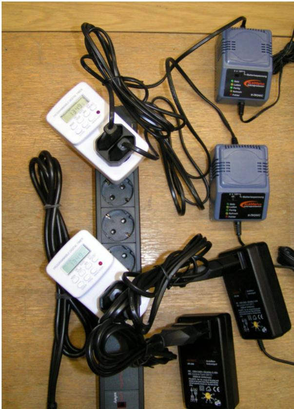
**Abbildung 5** Steckerleiste (mit integriertem Überspannungsschutz) mit zwei Zeitschaltuhren und angeschlossenen Geräten. Zeitschaltuhr „B“ mit Akku-Ladegeräten oben. Zeitschaltuhr „M“ mit Netzgeräten der Marderschrecks unten
