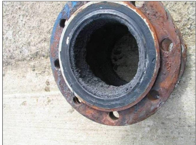
Abb. 12: Ablagerungen des Tiefenwassers an Bauteilen zur Nutzung der tiefen Geothermie (DEGERING & KÖHLER 2009: 6)
