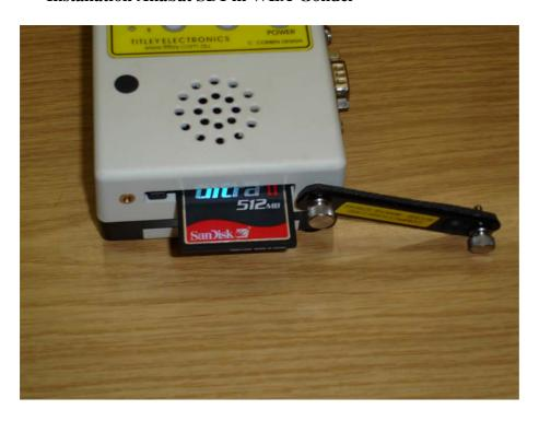
Abbildung 10 Einlegen bzw. Wechsel der CF-Karte beim Anabat SD1
