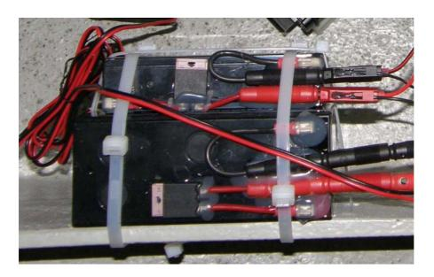
Abbildung 8 Befestigung des Blei-Gel-Akkus mit Kabelbindern (Breite 8 mm). Im Bild sind zwei Akkus gezeigt, für den Aufbau wird jedoch für jeden Detektor nur jeweils einer benötigt!
