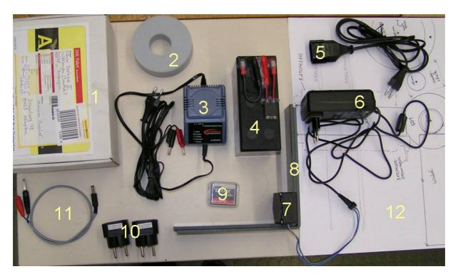
Abbildung 1 Geräte und Zubehör, das für die Installation des "Anabat SD1" **zusätzlich** in der WEA-Gondel pro Anlage mitzuführen ist
