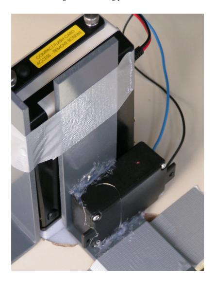
**Abbildung 12** Position des Anabat SD1 und des Marderschrecks an den PVC-Haltewinkeln. Der Marderschreck wird angeklebt an einem der Halterungswinkel des Anabat SD1 geliefert
