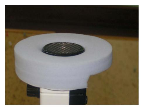
Abbildung 11 Aufstecken der Schaumstoffscheibe auf den Anabat SD1: Das Mikrofon sollte in einer Ebene mit der Schaumstoff-Front angeordnet sein. Die Aussparung im Schaumstoff sollte nach Hinten und zur Unterseite des Anabat SD1 weisen
