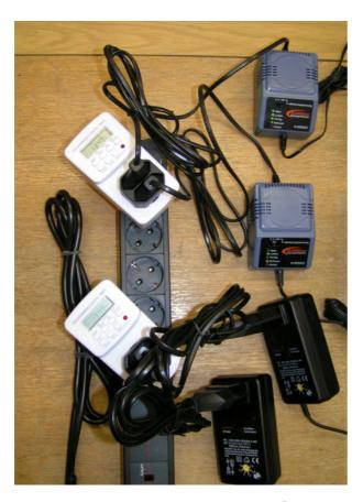
Abbildung 5 Steckerleiste (mit integriertem Überspannungsschutz) mit zwei Zeitschaltuhren und angeschlossenen Geräten. Zeitschaltuhr "B" mit Akku-Ladegeräten oben. Zeitschaltuhr "M" mit Netzgeräten der Marderschrecks unten
